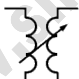
Transformador acoplamiento variable
