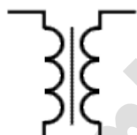
Transformador núcleo de Fe-Si
